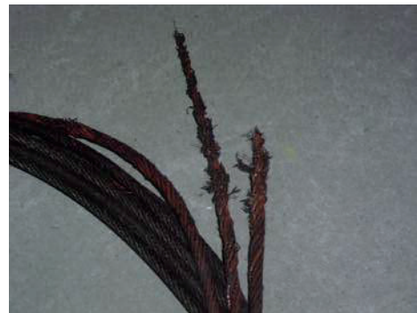
図3 ロープA、B破断部
