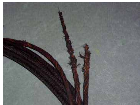
図3 ロープA、B破断部
